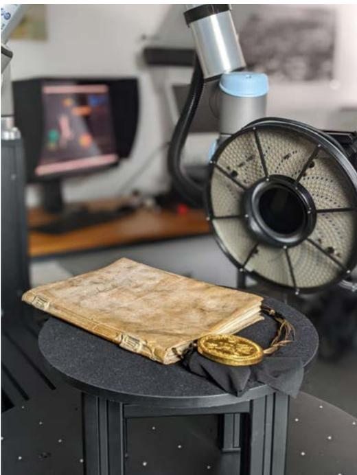
1 Die Goldene Bulle wird durch den beweglichen Roboterarm selbständig von allen Seiten aufgenommen und am Rechner in ein 3D-Modell umgewandelt.
