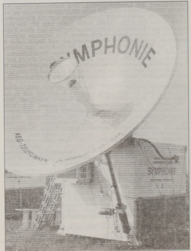
3,3-m-Antenne mit Container für das Satellitenprojekt „Symphonie“.
