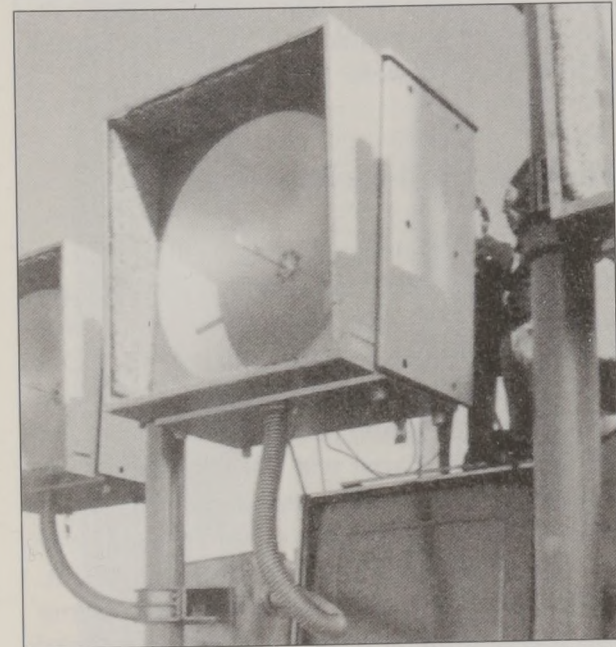
Erstes Digital-Richtfunksystem DRS 2x8 (2x2)/15000 im Erprobungsaufbau (oben) und im Wetzerschutzhäuser (unten).
