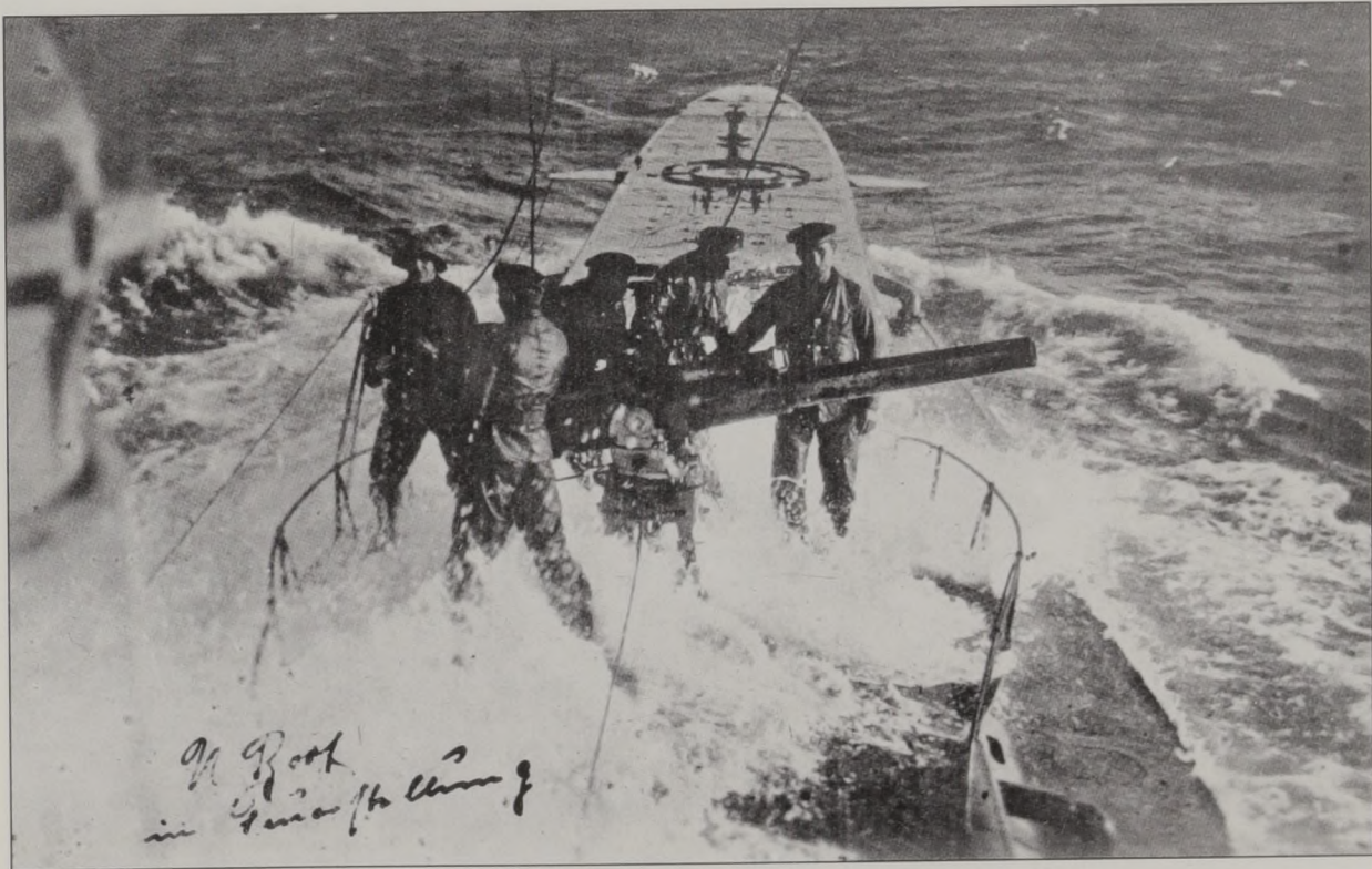
Das Bordgeschütz eines U-Bootes in Feuerstellung. Die Geschütze hatte bei den neueren Booten ein Kaliber von 10,5 cm. Die Artilleristen mussten bei jedem Seegang an Oberdeck einsatzbereit sein.
