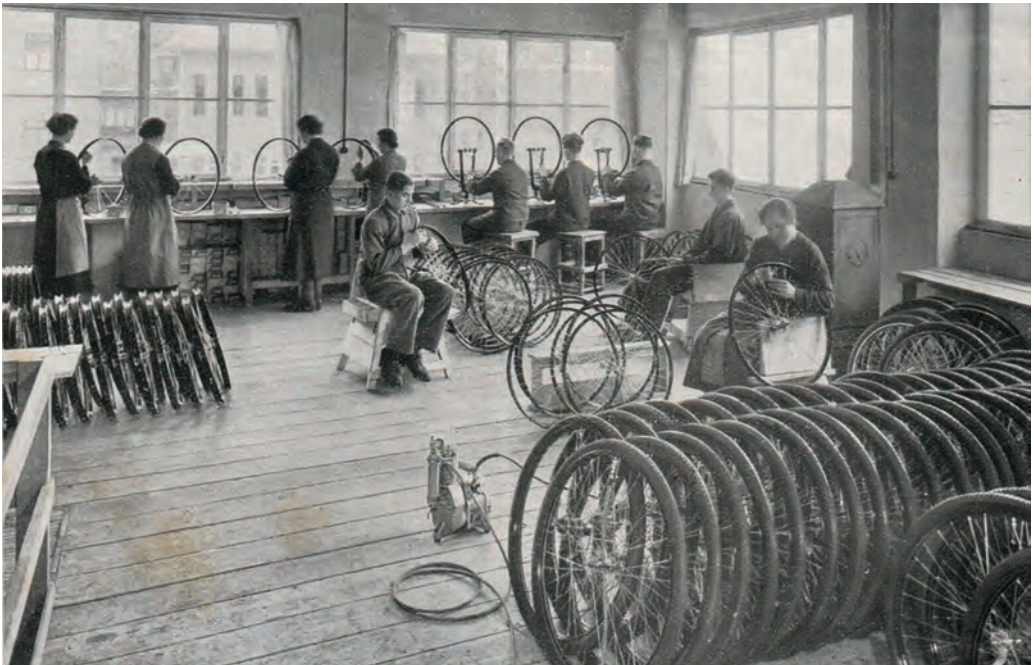
„In hellen, luftigen Räumen werden von eingearbeiteten Leuten die Laufräder eingespeicht, fertig gespannt und der Gummi aufgezogen“ (Jubiläumsschrift 1938).
