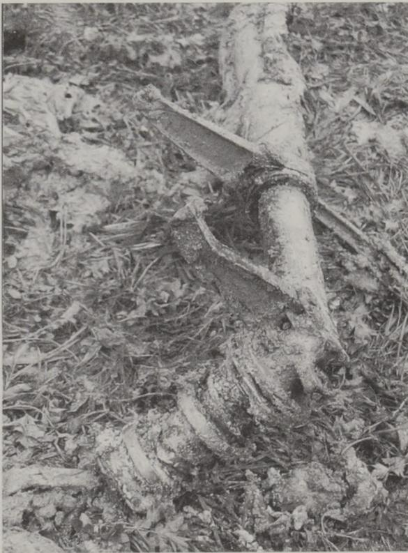
*Abb. 9: Federbein und Radachse des Fahrwerks.*
