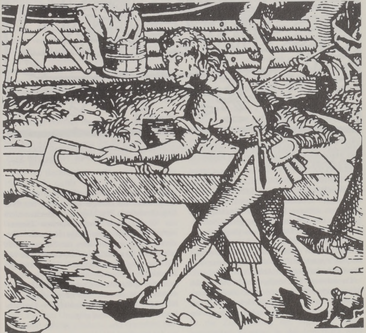
Abb. 6: Ein Schiffszimmermann beim Behauen eines schweren Balkens mit seiner langschneidigen Beschlagaxt aus Hartmann Schedels Weltchronik von 1493, Detail. Reproduktion.
