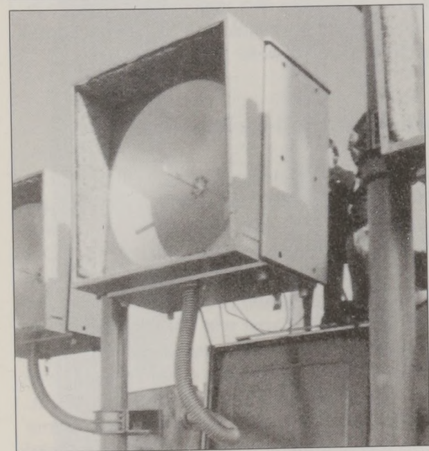
Erstes Digital-Richtfunksystem DRS 2x8 (2x2)/15000 im Erprobungsaufbau (oben) und im Wertschutzgehäuse (unten).
