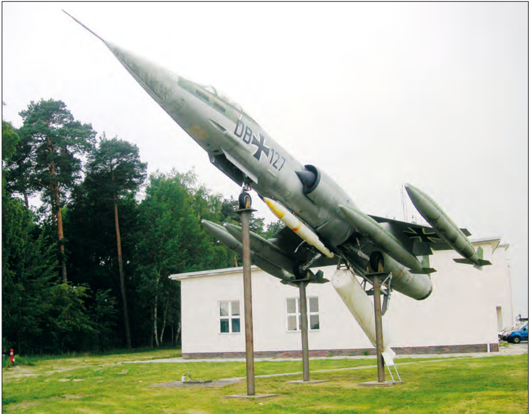
Der Jagdbomber Starfighter F-104 G im Luftwaffenmuseum in Berlin-Gatow. Am Rumpfende ist ein Strahltriebwerk als Startunterstützung und zur Beschleunigung auf 2 100 km/h montiert. Unter den Flügeln befinden sich Außenlasttanks, unter dem Rumpf hängt eine Bombenattrappe und unter dem Schrifzug ist der Schießkanal für die 20-mm-Maschinenkanone zu erkennen.
