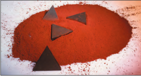
Gemischtes Oxid-Ferritpulver mit einigen daraus gepressten und gesinterten Ferriten.
