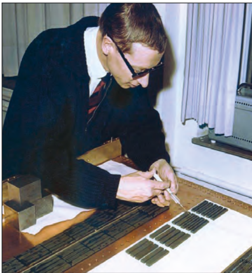
Dr. Erich Pivits beim Kleben der Ferrite des Leistungszirkulators für DESY.
