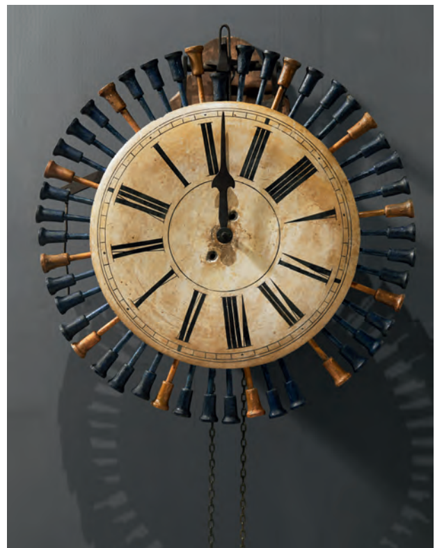
Stationäre Wächterkontrolluhren wurden an markanten Stellen im Ort aufgestellt. Durch den Kettchenzug löste der Wächter ein Hämmerchen oben an der Uhr, der die hölzernen Dübhel eindrückte. Es drehte sich nicht der Zeiger, sondern das Zifferblatt samt den Dübhel. Am nächsten Tag konnte der Kontrolleur an den heruntergedrückten Dübhel ablesen, wann der Wächter vor Ort gewesen war.
