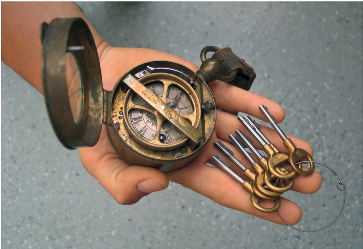
Tragbare Wächterkontrolluhr. Der Nachtwächter betätigte mit an festen Stationen angebrachten Markierschlüsseln in der Uhr eine Federzunge, die ein Loch in den Papierstreifen drückte. Jeder Schlüssel erzeugte eine andere Lochung. Somit war der Rundgang des Nachtwächters nachvollziehbar.
