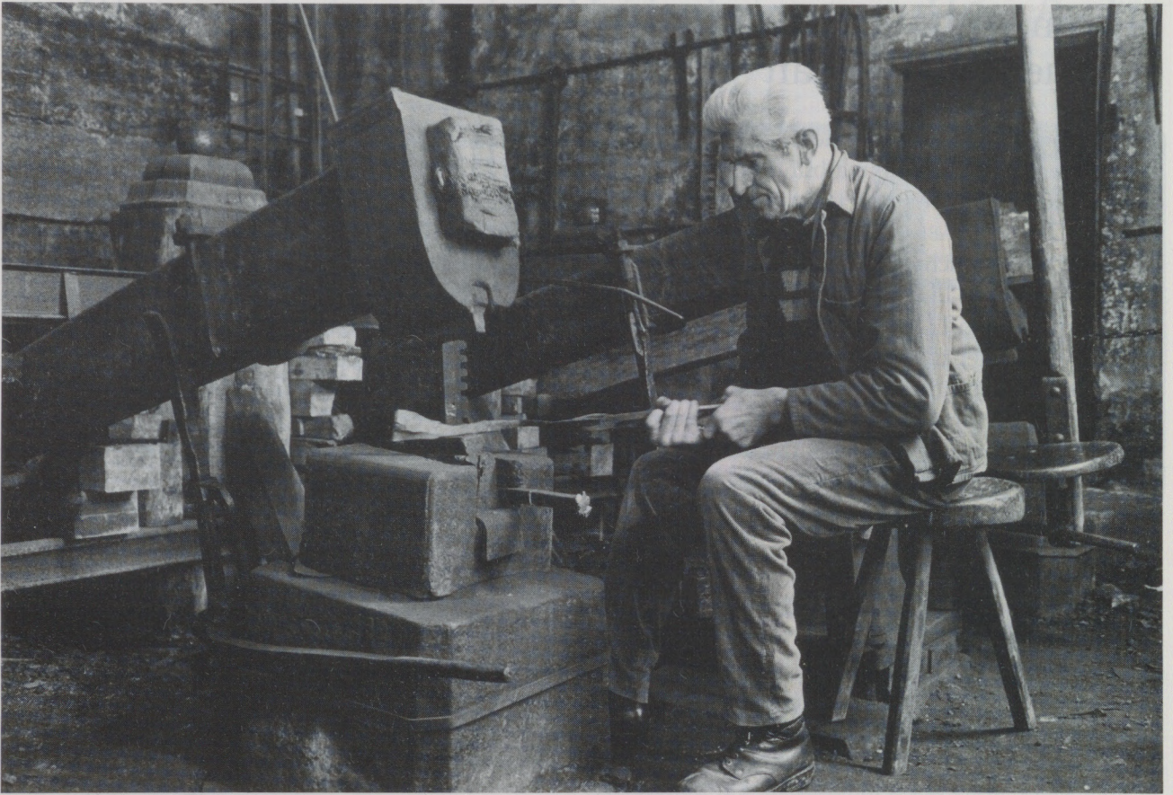
Schmiedemeister Ströbel arbeitet mit dem Schwanz- oder Fallhammer, der mit Wasserkraft angetrieben wird.
