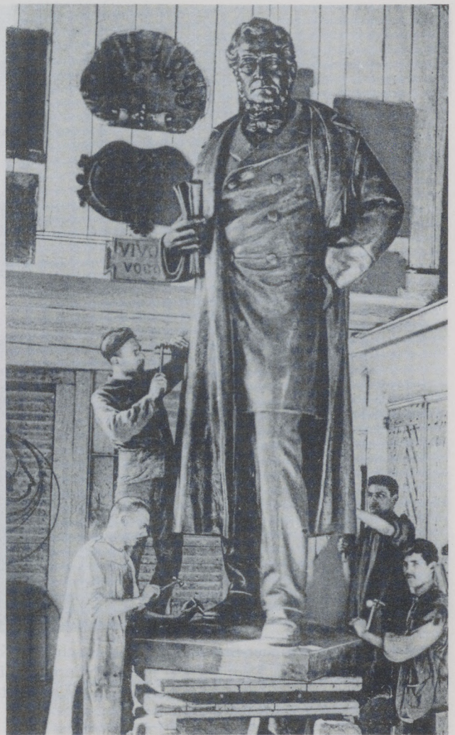
Blick in die Werkstatt von Hugo Pelargus: Arbeiter machen den Guß eines Denkmals des Chemikers Robert Wilhelm Bunsen fertig.
