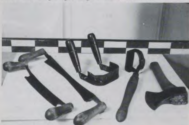
Geräte zum «Röten»: Schneid- oder Schnitzmesser, zwei- und eingriffiger Bügelschaber, Handbeil.
