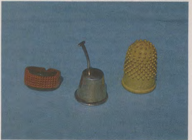
Spezialfingerhüte. Von links: japanischer Lederfingerring, Fingerhut eines Augenarztes zum Nähen und Gummifingerhut zum Geld- und Seitenzählen.
