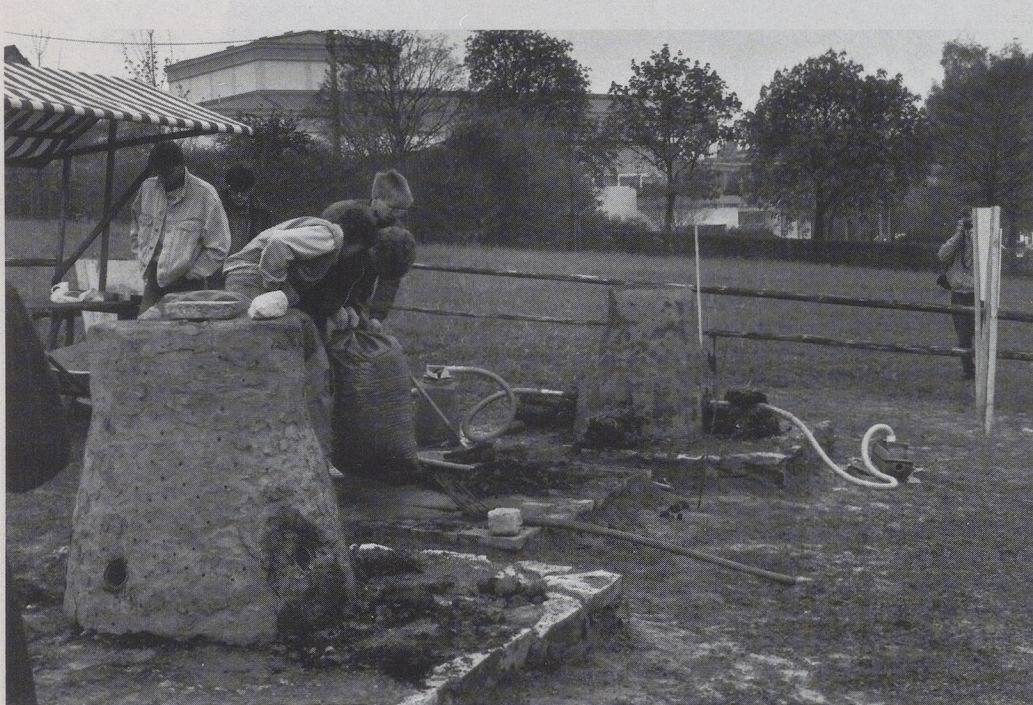
Trotz kräftigen Staubsaugergebläses ist in Hubers nachgebautem Rennofen bei der Demonstration neben dem Limesmuseum in Aalen 1991 kein schmelzbares Eisen erschmolzen worden.
