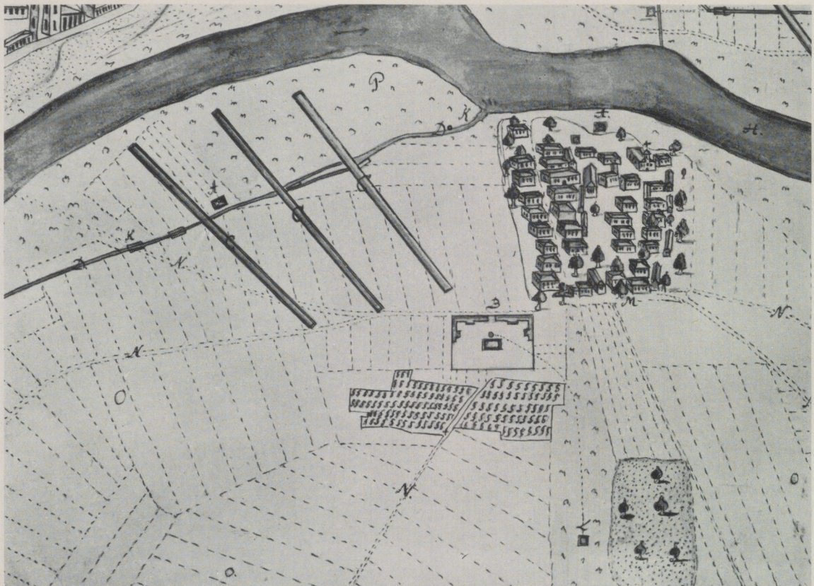
Saline Clemenshall. Entwurfsplan von 1754. In der Bildmitte Grundriß der Salinengebäude, rechts oben Ansichtszzeichnung des Ortes Offenau, links oben Salinenkanal und drei Gradierwerke. Am südlichen Bildrand neben dem Wäldchen die Trinkwasserquelle der Saline. Rechte obere Ecke: Teil der projektierten Saline Heinsheim.
