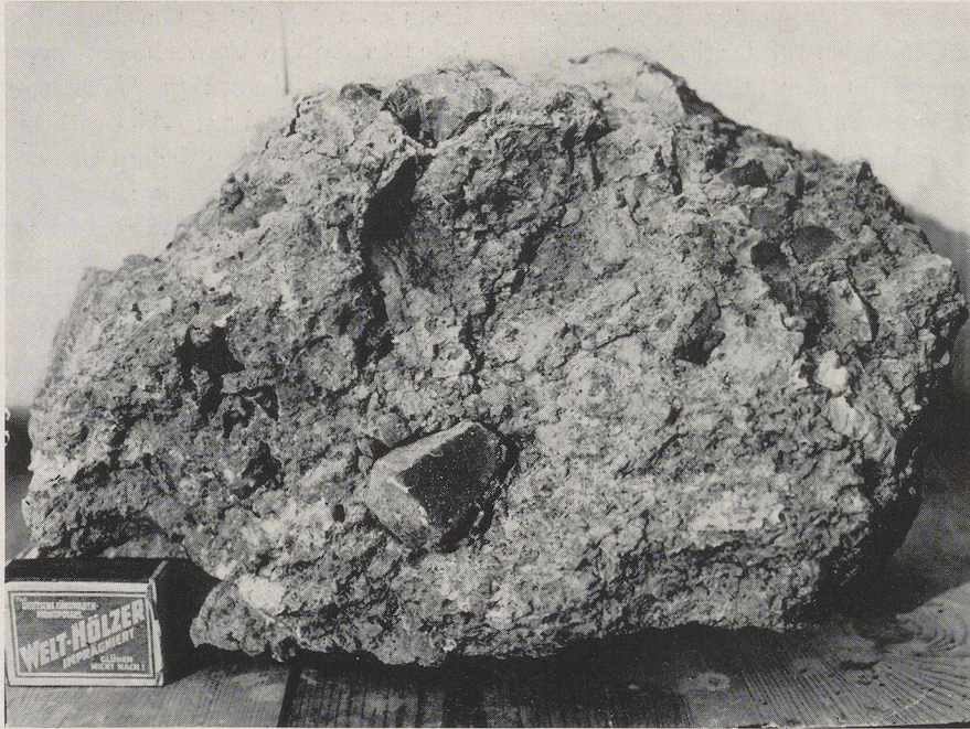
3. Verlehmter Mylonit der Spaltenfüllung der Stirnwand des Grabeneinbruchs
