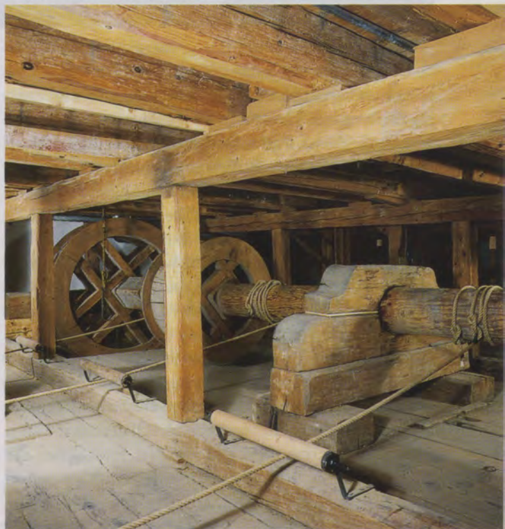
Unten: Der große Wellbaum mit dem Gewichtsrade ist der Kraftprotz des Ludwigsburger Barocktheaters.
