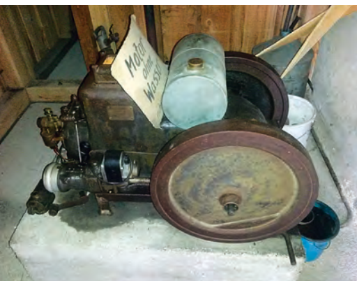
Läuft wieder: der historische 5-PS Benzinmotor der Firma Schlüter.
