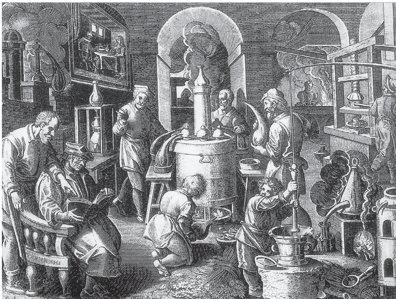
Kuperstich von Jan van der Straet, Antwerpen 1600: fürstliches chemisch-alechemistisches Laboratorium. Hinten links Verbundofen mit Destillationsapparat, rechts davon Filtrationsvorrichtung. In der Mitte Ofen mit Wasserbad und Destillationsapparaten. Hinten rechts Esse und Pflanzenpresse, vorne rechts zwei Öfen zum Destillieren. Links Mörser mit Pistill an Hebevorrichtung.
