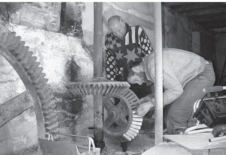
Einsetzen von Zähnen aus Buchenholz in das Getriebe.
