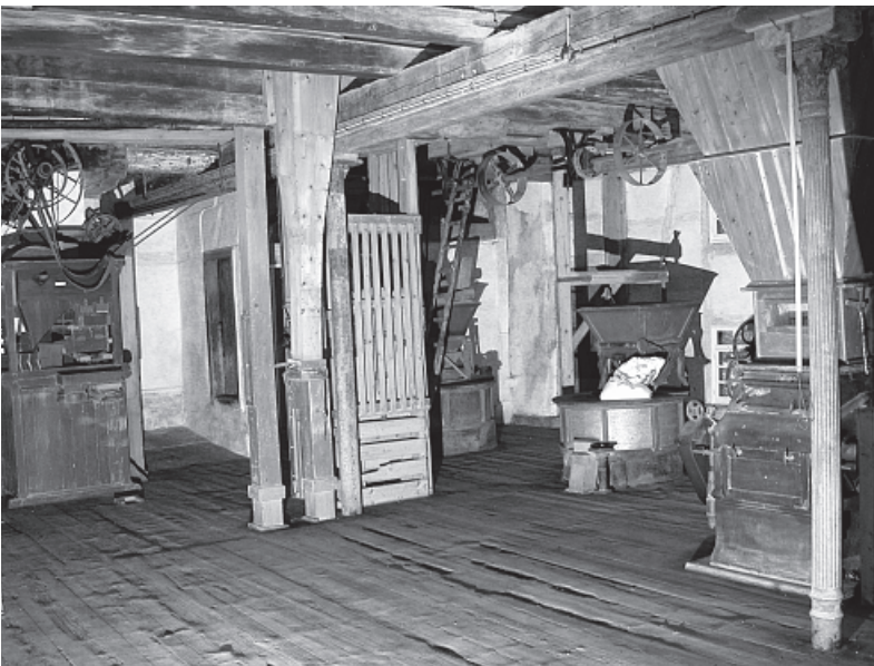
Inneneinrichtung der Mühle mit der Transmission.
