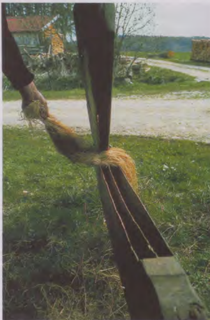
Von links: Geöffnete Flachsbreche vor dem Niederdrücken – Über Schwingschemel werden mit Schwingmesser Stängelreste herausgeschlagen – Der geschwungene Flachs wird gehechelt.
