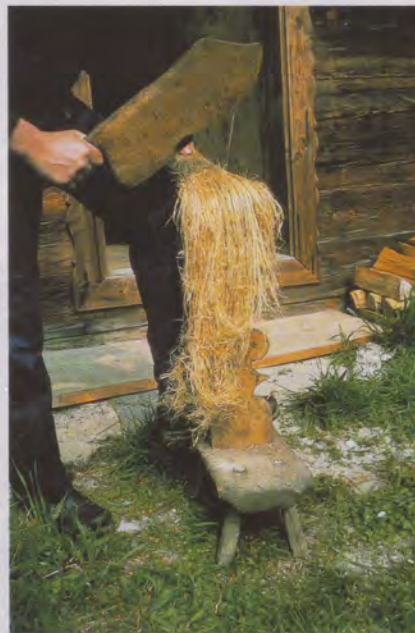
Von links: Geöffnete Flachsbreche vor dem Niederdrücken – Über Schwingschemel werden mit Schwingmesser Stängelreste herausgeschlagen – Der geschwungene Flachs wird gehechelt.
