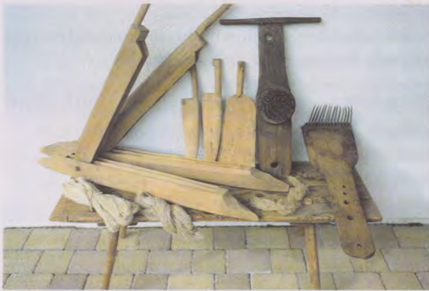
Geräte der Flachsbearbeitung, von links: zwei geöffnete Flachsbrechen ohne Böcke, drei Schwingmesser, eine Hechel und ein Riffelkamm mit einem variabel aufhängbarem Brett für das senkrechte Riffeln.
