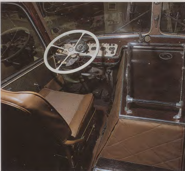
Als sich der Motor noch neben dem Fahrer befand: «Cockpit» des «Schweizer-Busses» (1954).
