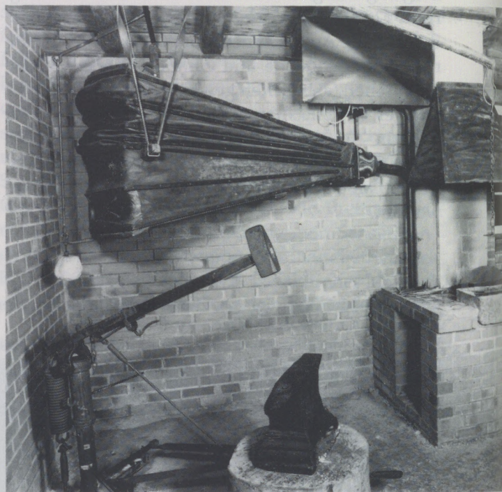
Esse mit Blasebalg; im Vordergrund steht ein Fußhammer. Unten das verzierte Mundstück des Blasebalgs.
