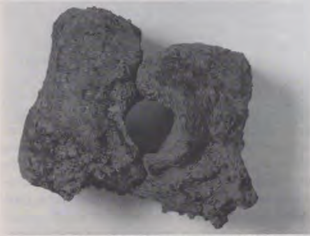
Durch das runde Loch dieses Düsenziegels ist Frischluft in den Rennofen geblasen worden, der irgendwo auf den Essinger «Weiherwiesen» gestanden war.
