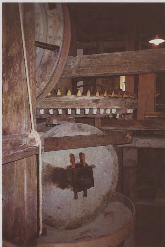
Öltisch (Kollergang) mit zwei mächtigen Läufern aus Stein. Hier wurden die Ölfrüchte wie Lein-, Mohn- und Rapssamen und in geringerem Umfang auch Bucheckern und Walnüsse zerquetscht.
