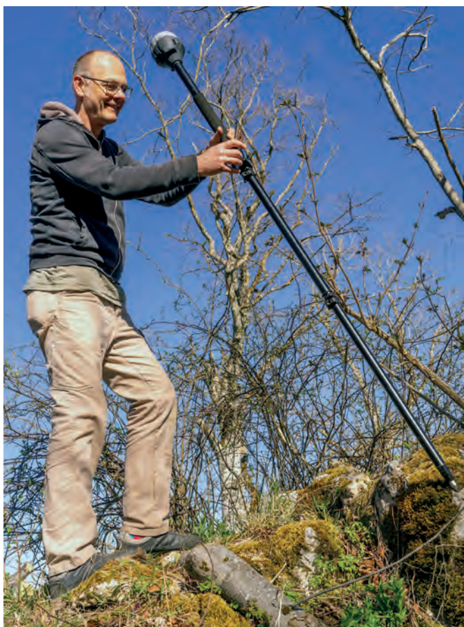
Sören Frommer beim Survey: Mit dem GPS-Gerät an einem langen Stab kann man Fundstellen zentimetergenau verorten.
