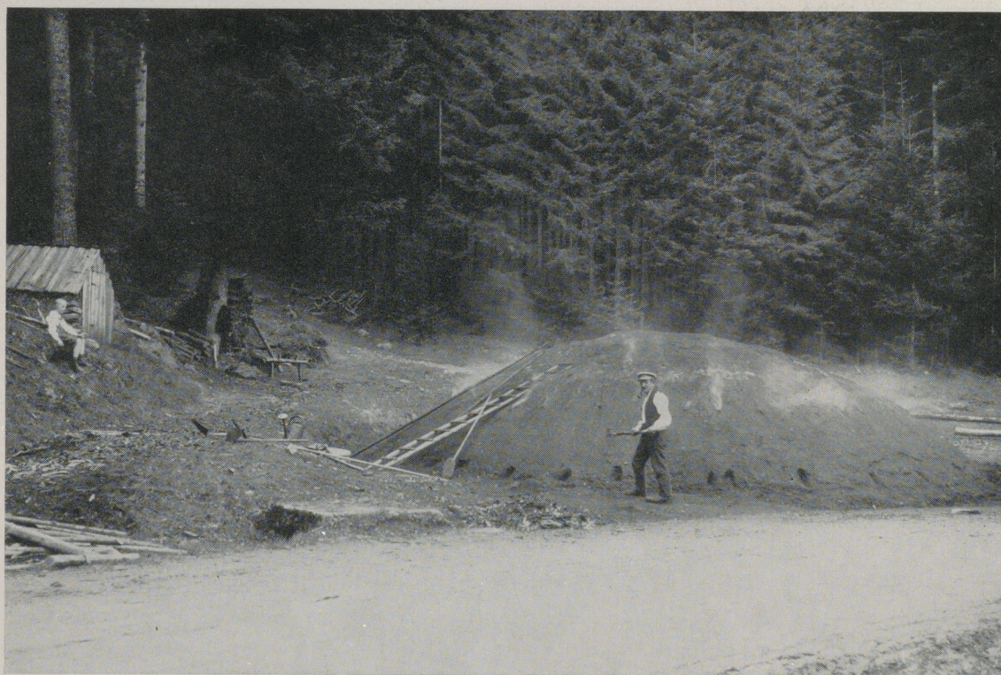
10. Ein neues Rauchloch wird eingestoßen. Agenbach.
