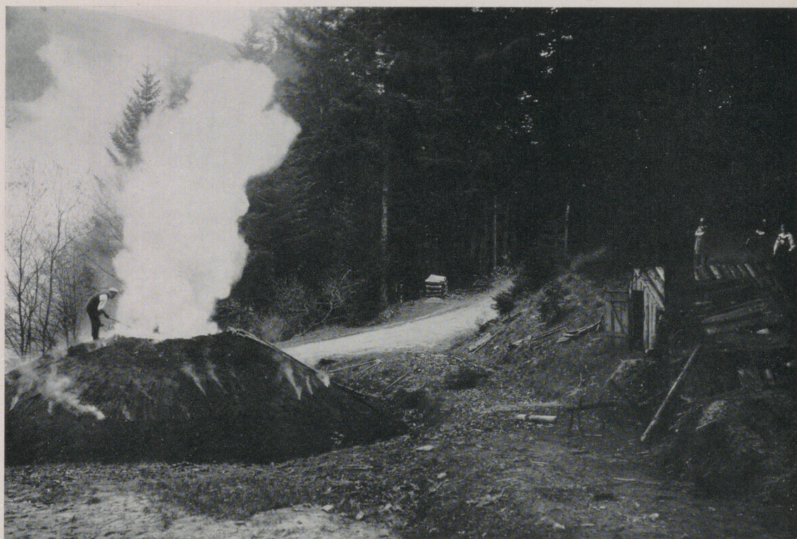
8. Das Schürloch ist zum Nachfüllen geöffnet, Agenbach.
