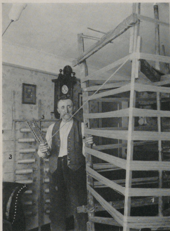
6. an der Zettelrahm (1 l. Hand); das „Zettelbrett“ (2), in der r. Hand; dahinter das „Zettelgätter“ (3)
