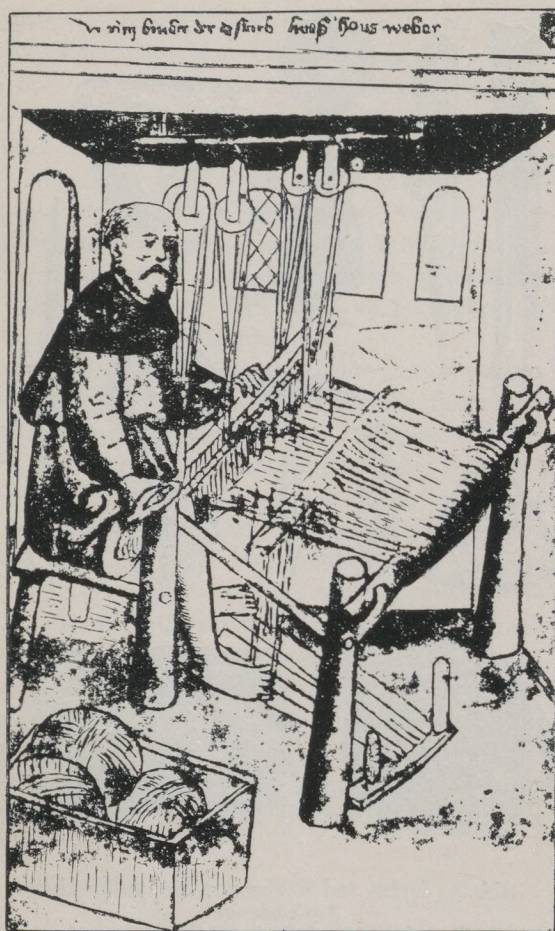
Abb. 3: Mittelalterlicher Webstuhl (nach dem Mendelschen Hausbuch um 1385); die Webgeschirre hängen an 2×2 Rollen; l. Hand an der Lade, r. Hand mit dem „Schützen“ (Schiffchen); neuartig die (barfuß bedienten!) Tretschemel; l. vorn Garnknäuel; bei uns im S. in Strängen
