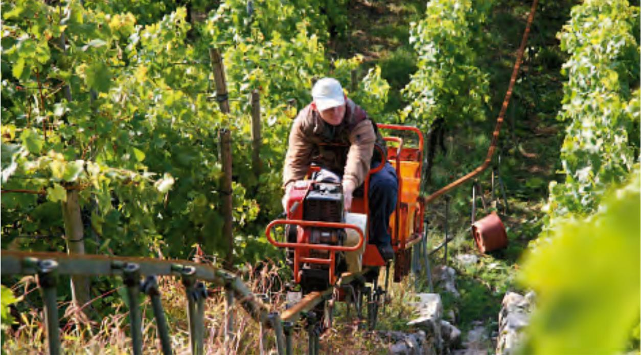
Der Lift des Wengerters: Monorackbahnen wie hier in Hessigheim kommen auch bei der Lese zum Einsatz. Mit dem Einschienen-Zahnrad-Transportmittel lassen sich selbst extreme Steigungen überwinden. Das Land bezuschusst den Bau mit 60 Prozent.
