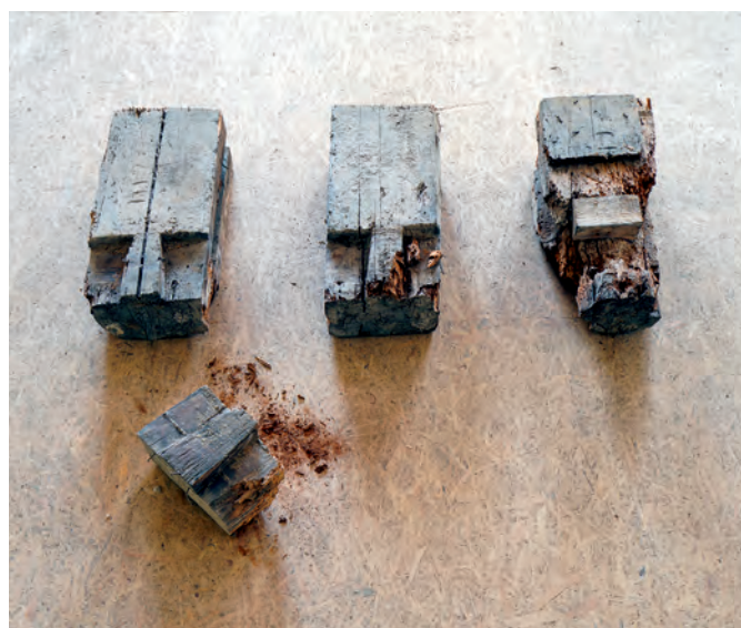
Schwalbenschwanzverbindungen an schadhaften Balkenköpfen, die an der Ostseite der Decke über dem Erdgeschoss entnommen wurden. Sie deuten auf die handwerklichen Fertigkeiten der der Zimmerleute hin, die das Haus 1783–85 bauten.
