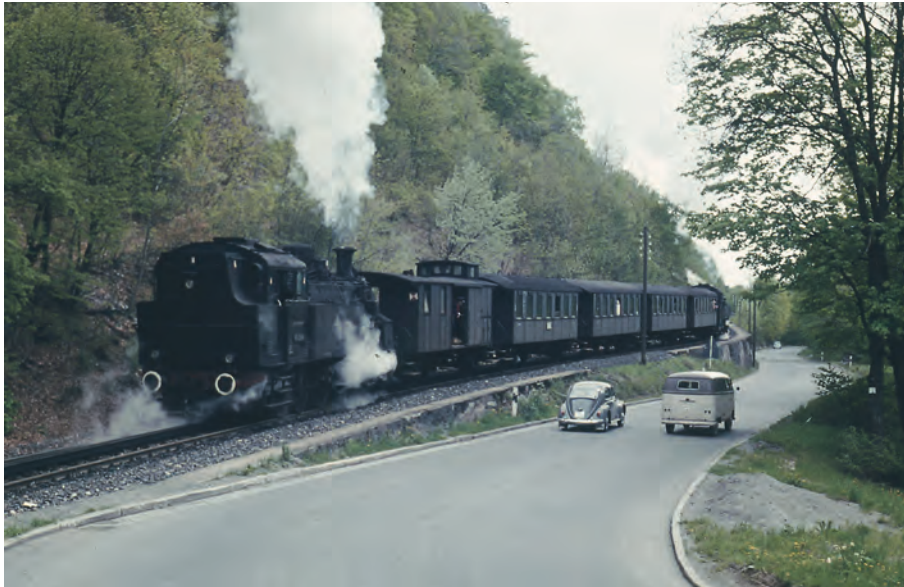
Eine württembergische Zahnradlokomotive, Klasse Hz bzw. BR 97 504, leistet zwischen Honau und Lichtenstein einem Personenzug mit einer württembergischen T5-Lok nach Münsingen Nachschub auf der Zahnstange. Der Streckenabschnitt Honau–Lichtenstein wurde bereits 1969 stillgelegt. Foto ca. 1950.
