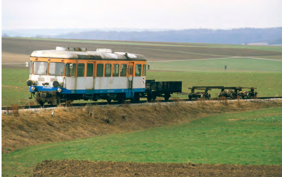
Rasch nach der Einstellung des Betriebes wurden die Schienen der Strecke Amstetten-Laichingen entfernt: Ein Schweißer trennte die Gleise in kurze Joche und ein Zweiradgebagger legte sie auf ein eigens dafür aus zwei Rollböcken zusammengeschaubtes Fahrzeug. Der Triebwagen T30 verrichtete so noch «gute» Dienste. Foto, 16. September 1985.
