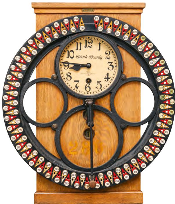
*Dieser Radialapparat, auch Hebelapparat genannt, wurde von der Württembergischen Uhrenfabrik ab 1900 in Lizenz für die amerikanische Bundy Manufacturing Company produziert. Sie erfasste die Arbeitszeit von bis zu hundert Arbeitern, indem diese mit dem Hebel unten in das mit ihrer persönlichen Nummer gekennzeichnete Loch stachen. Diese Nummer wurde so auf eine Papierrolle neben der Uhrzeit gedruckt.*
