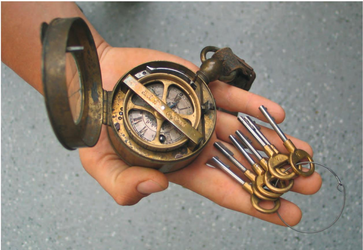
*Tragbare Wächterkontrolluhr. Der Nachtwächter betätigte mit an festen Stationen angebrachten Markierschlüsseln in der Uhr eine Federzunge, die ein Loch in den Papierstreifen drückte. Jeder Schlüssel erzeugte eine andere Lochung. Somit war der Rundgang des Nachtwächters nachvollziehbar.*
