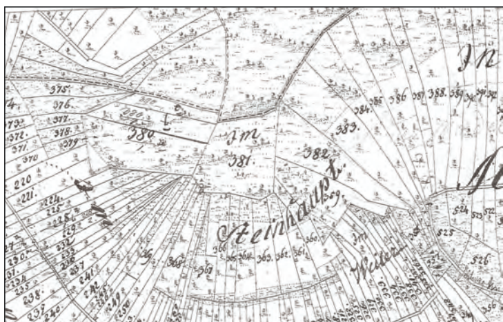
Flurkartenausschnitte vom Grafenberg von 1823 und heute: Links ist die Urkarte zu sehen, die im Rahmen der von König Wilhelm per Dekret 1818 verordneten und bis 1840 durchgeführten württembergischen Landesvermessung (1818–1840) entstand. Gut zu erkennen ist die durch die Realteilung forcierte Besitzersplitterung. Die aktuelle Flurkarte (rechts) zeigt die aktuellen Grundstücksgrenzen; die blauen Flächen befinden sich im Eigentum des Schwäbischen Heimatbundes. Die einst schmalen Streifen der Flur Steinhaupt fasste der Heimatbund zu zwei Flurstücken zusammen. In der östlichen Flur Mädél erwarb der Heimatbund die Flurstücksteile im oberen Hang und verschmolz sie ebenfalls zu zwei Flurstücken.
