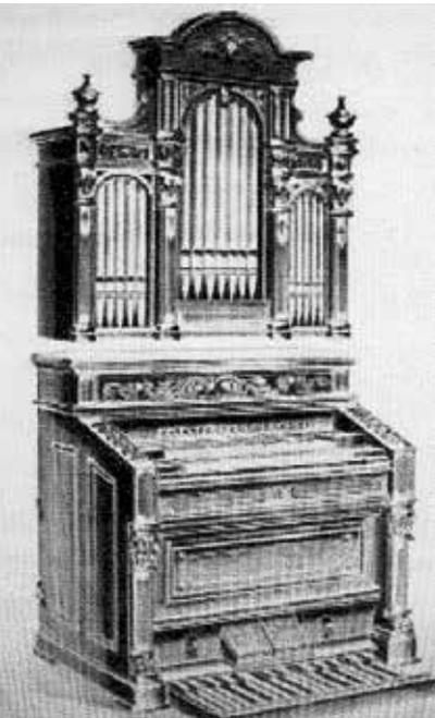
Abb. 17 - Das Kirchen-Pedal-Harmonium mit Pfeifenauflauf im gotischen Stil und Lufterzeugung durch ein elektrisches Schleudergebläse beeindruckte die Fach-Besucher. (Foto: VOX HUMANA).
