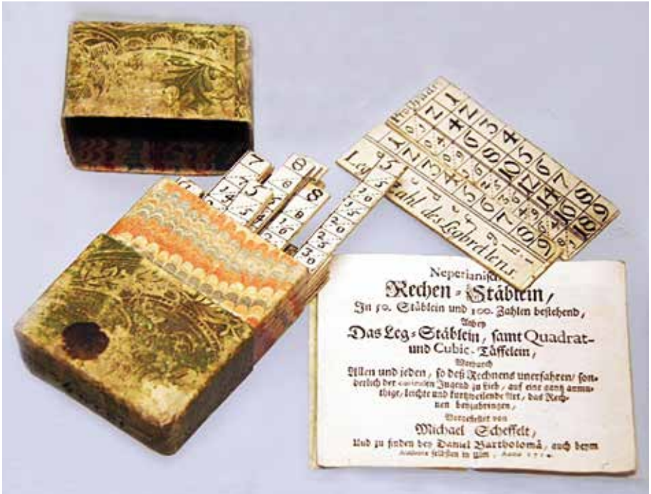
Abb. 18 - Die Abbildung zeigt das Stuttgarter Exemplar von Scheffelts Neperianischem Rechen=Stäbchen samt Anleitung (Foto: Landesmuseum Baden-Württemberg Stuttgart).
