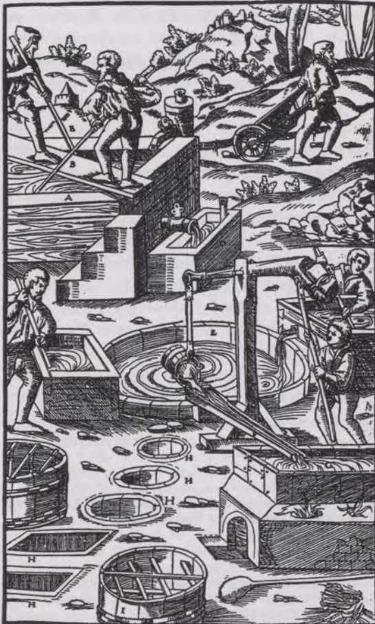
Der große Behälter A. Stangen B. Der Zapfen C. Wanne D. Der runde Behälter E. Die Rinne F. Die Bleipfanne G. In die Erde eingegrabene Gefäße H. Kufe mit Stäben I.
