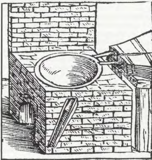
Abb. 5 Schmelzofen mit Blasebalg (V. Biringuccio: De la Pirotechnia , 1540)
