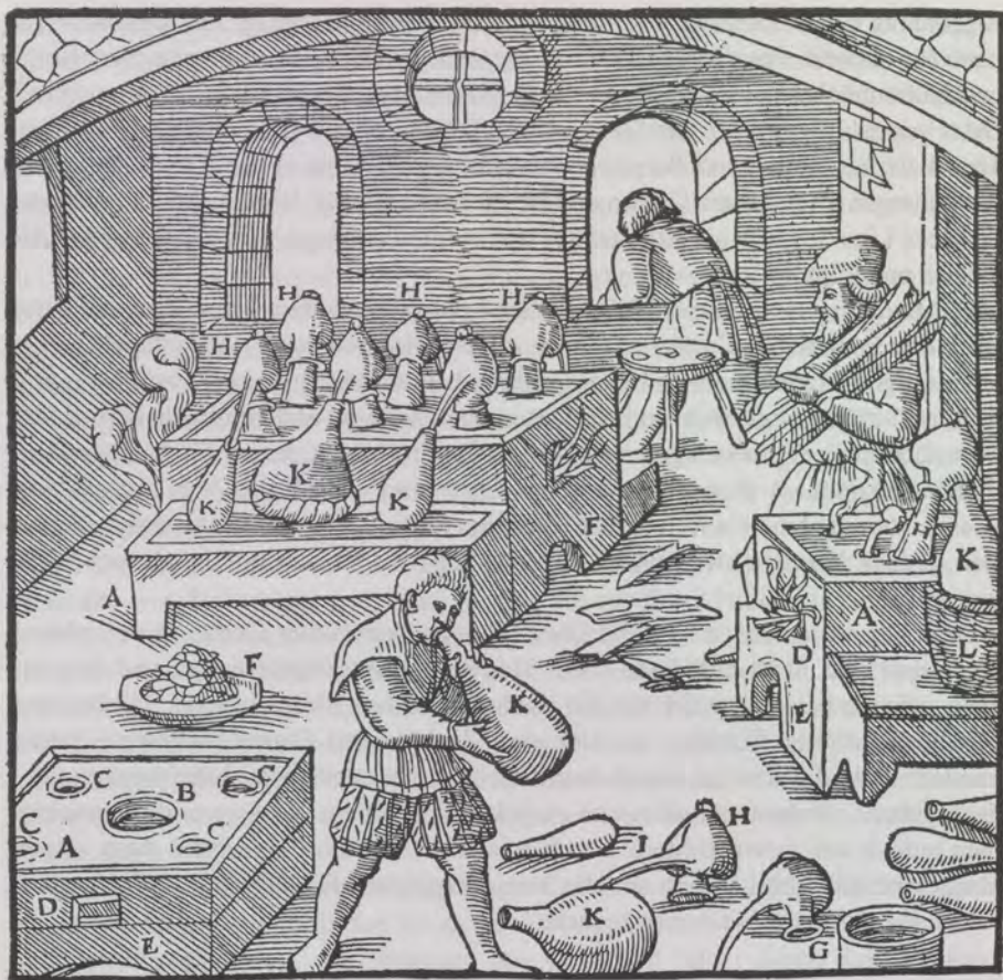
Abb. 1 Berg- und Hüttenlaboratorium, in dem „Scheidewasser“ (Salpetersäure) zur Trennung von Gold und Silber in Destillationsapparaten hergestellt wird (G. Agricola: De re metallica libri XII , Basel 1556, S. 357. – Deutsch: Zwölf Bücher vom Berg- und Hüttenwesen , Berlin 1928, S. 383. – Mit freundlicher Genehmigung der Georg-Agricola-Gesellschaft).
