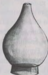
2 Helm mit Ansatz für Rohrschlangen
