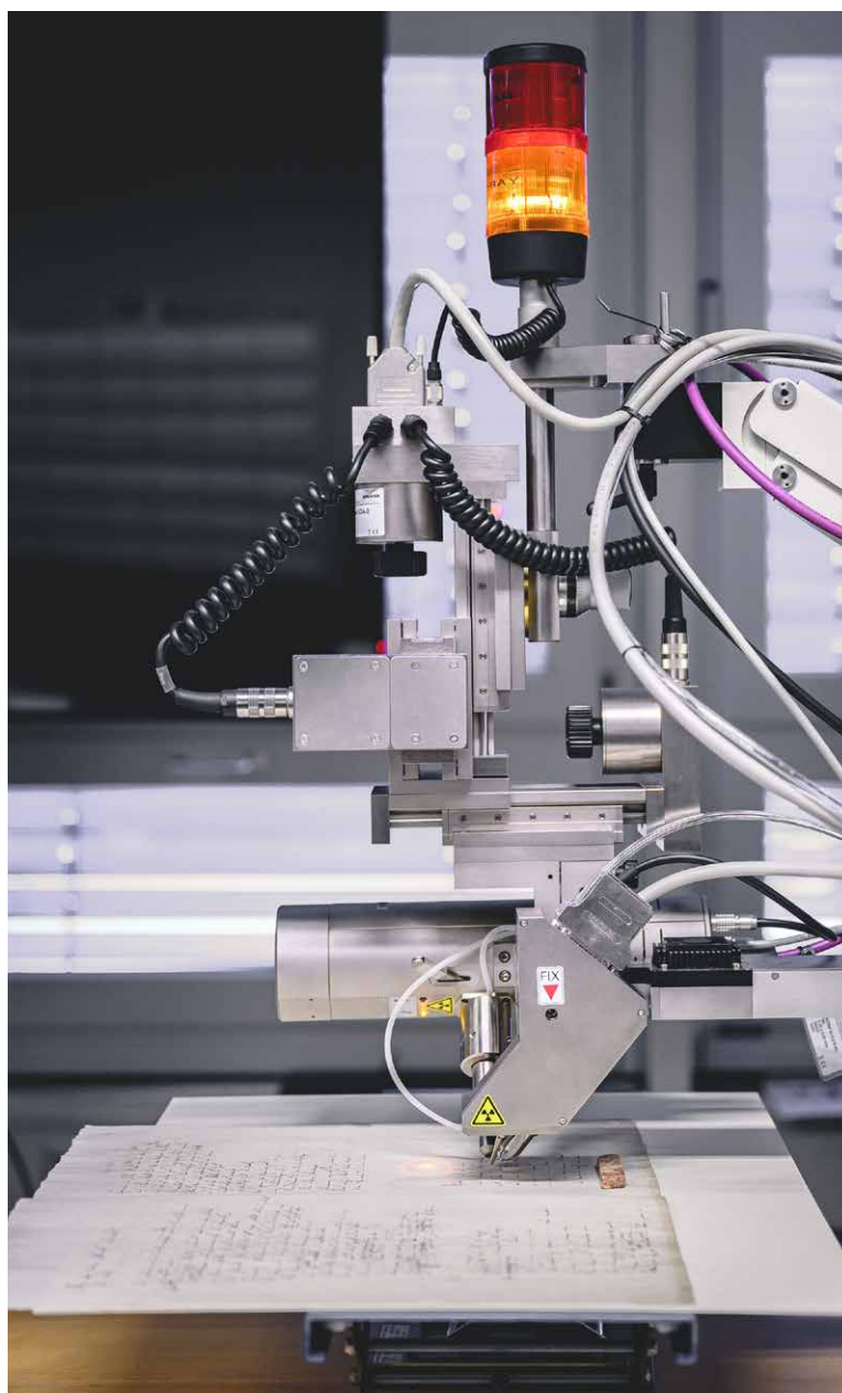
Abb. 2: Messkopf des Röntgenfluoreszenzspektrometers über einer Seite des Homburger Foliohefts. Foto Marcel Katz
