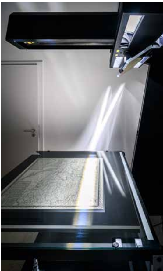
Über den Spiegel wird die Vorlage an den Sensor übertragen.
