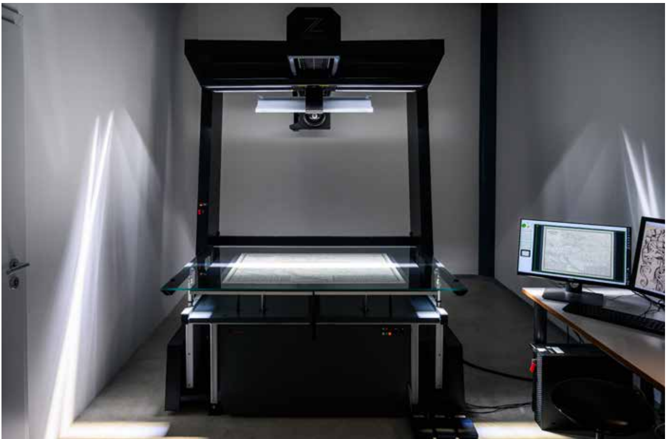
Der neue Großformatscanner mit der größeren A0-Buchwippe
