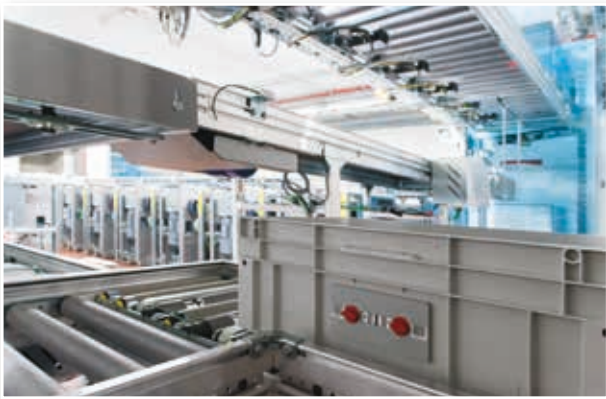
Abb. 5: Die Codier-Schablone an der Außenseite dient zur Identifikation des Behälters
