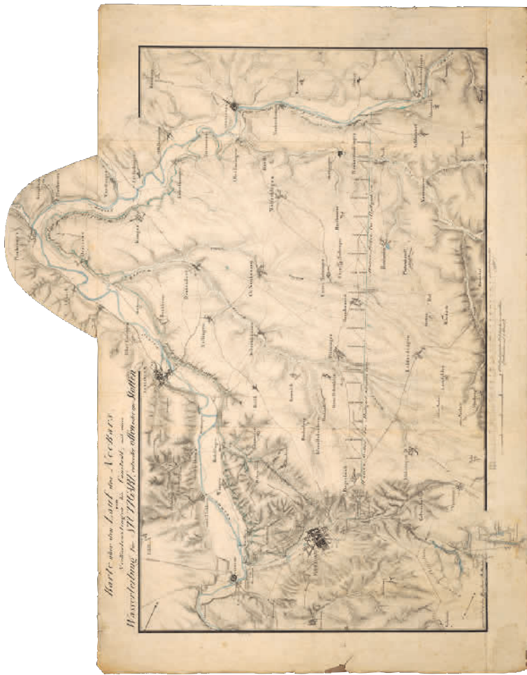
Abb. 1: Karte des Neckars und der Filder, mit Einzeichnung des Neckarstollens von Neckartenzlingen nach Heslach und eines offenen Wasserkanals von Neckartenzlingen bis Hedelfingen und einem Stollen von Rohracker bis zum Bopser, von August Friedrich Durtenhofer, 1835 (HStA Stuttgart N 60 Nr.33).
