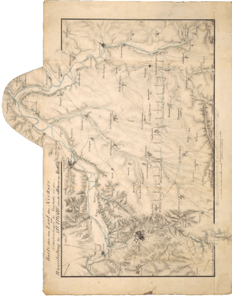
Abb. 1: Karte des Neckars und der Filder, mit Einzeichnung des Neckartollens von Neckartenzlingen nach Heslach und eines offenen Wasserkanals von Neckartenzlingen bis Hedelfingen und einem Stollen von Rohracker bis zum Bopser, von August Friedrich Durtenhofer, 1835 (HStA Stuttgart N 60 Nr.33).
