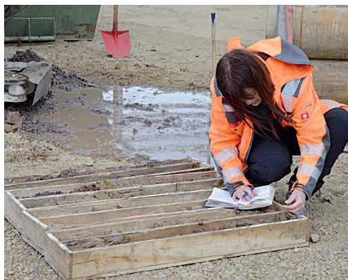
Schicht um Schicht wurde aus dem Boden geborgen, bis in 13,7 Metern Tiefe genügend Wasser für den Brunnen gefunden wurde.
