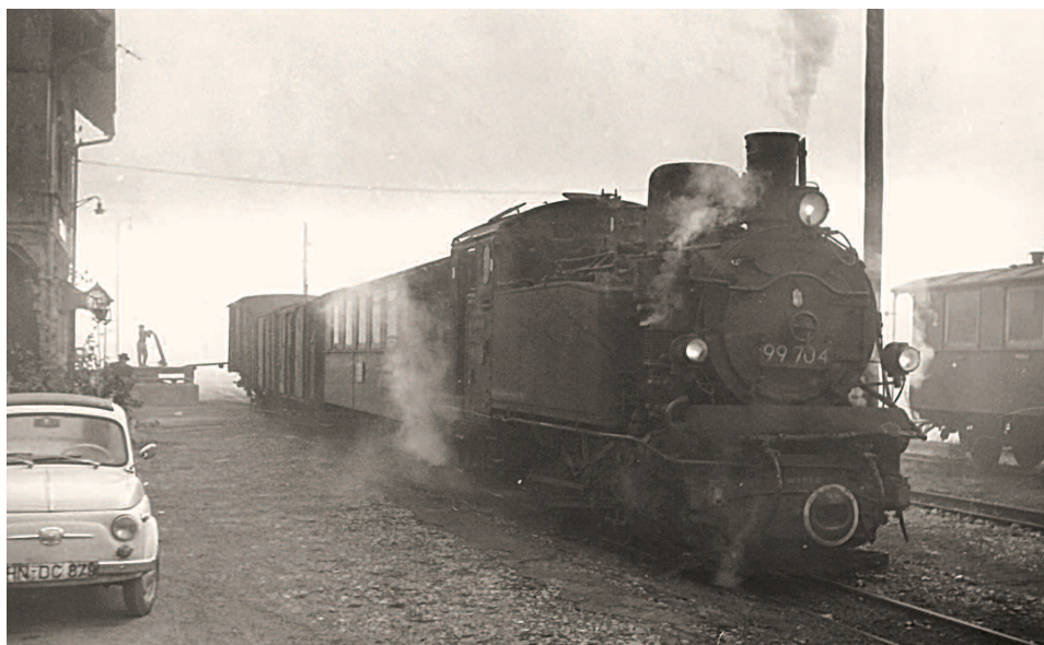
Im kurzen Güterzug mit Personenbeförderung (GmP) wird der am Zugende sich befindliche aufgeschemelte gedeckte Normalspurgüterwagen am 11. Februar 1963 in Güglingen entladen. (Foto: Sigurd Hilkenbach)
