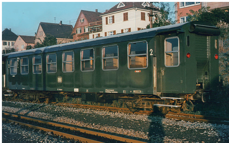
Bottwartal statt Zabergäu, hieß es nach Fertigstellung des einzigen Neubaupersonenwagen mit 750 mm Spurweite der Deutschen Bundesbahn. Bei den Reisenden, wie hier in Marbach am Neckar, wurde der vierachsige Wagen wegen der guten Federung und den modernen sitzen als „Salonwagen“ bezeichnet. (Foto: Dieter Junker, Sammlung Eisenbahnstiftung)
