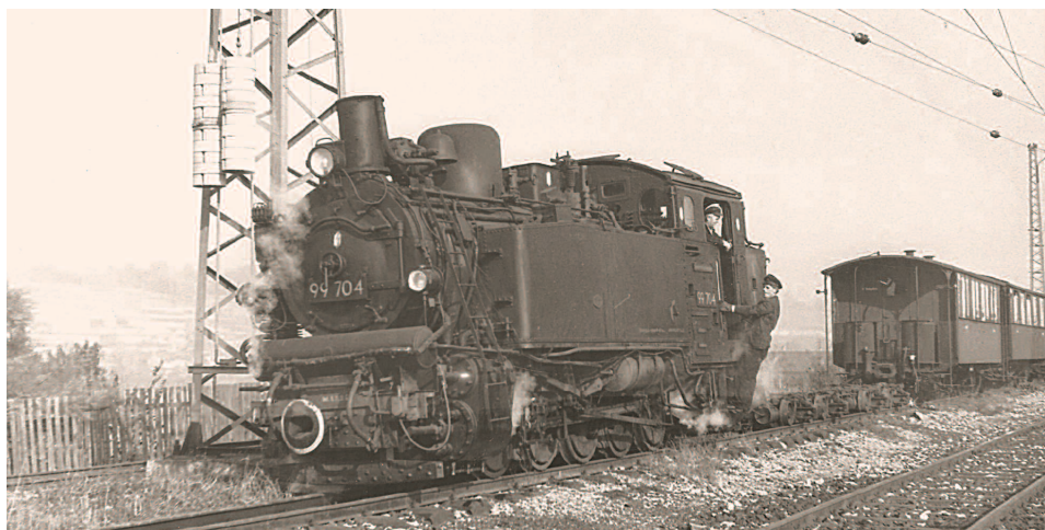
Die fünfachsigen Lokomotiven der Gattung sächsische VI K und deren Nachbauserie, wie hier die 1926 in Karlsruhe gebaute 99 704 in Lauffen am 11. Februar 1963, besorgten bis zum Streckenumbau den Betriebsdienst. (Foto: Sigurd Hilkenbach)
