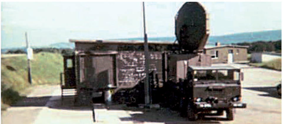
Das zur Pershing gehörende TRC-80-Radar am Ort der alten Nike-Feuerleitstelle. Es war ganz anders aufgebaut als das frühe Nike-Radar (Bild: www.usarmygermany.com )
