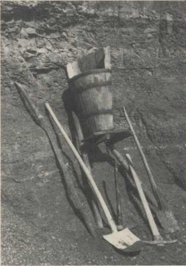
Arbeitsgeräte beim Erdtragen: Erdbutten, Erdesel, zugespitzte Wagenachse, Schaufel, Spitzhacke und Pickel.
