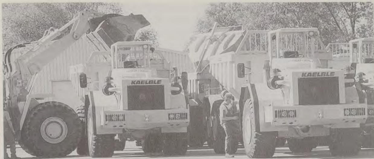
Von der Bauindustrie gefragt: generalüberholte Spezialkipper für den Bau von Tunneln der ICE-Neubaustrecke.
