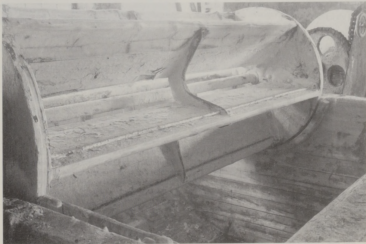
Dieser Äscher-Haspel wurde 1990 vor Abbruch der Firma Carl Kaess aufgenommen. Unbekannt ist, ob die um 1870 verwendeten Haspel für die erheblich kleineren Farben (ca. 1,25 x 1,25 m) von gleicher Bauart waren.
